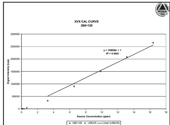
**HD – 2,2'-Di(chloroethyl)sulfide**
